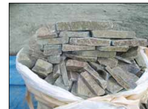
コバ積み石（ t = 30\text{mm} から 200\text{mm} ）
