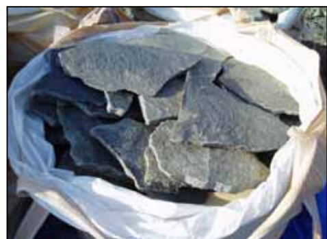
鉄平石（ t = 10\text{mm} から 30\text{mm} ）張石（ t = 10\text{mm} \sim 50\text{mm} ）
