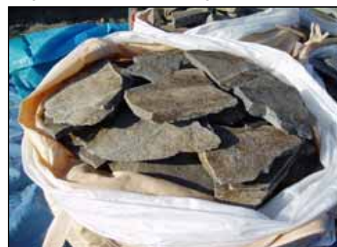
鉄平石（ t = 10\text{mm} から 30\text{mm} ）張石（ t = 10\text{mm} \sim 50\text{mm} ）
