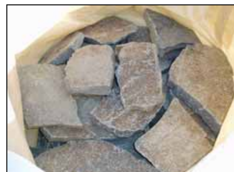
平石（ t = 30\text{mm} \sim 100\text{mm} ）
